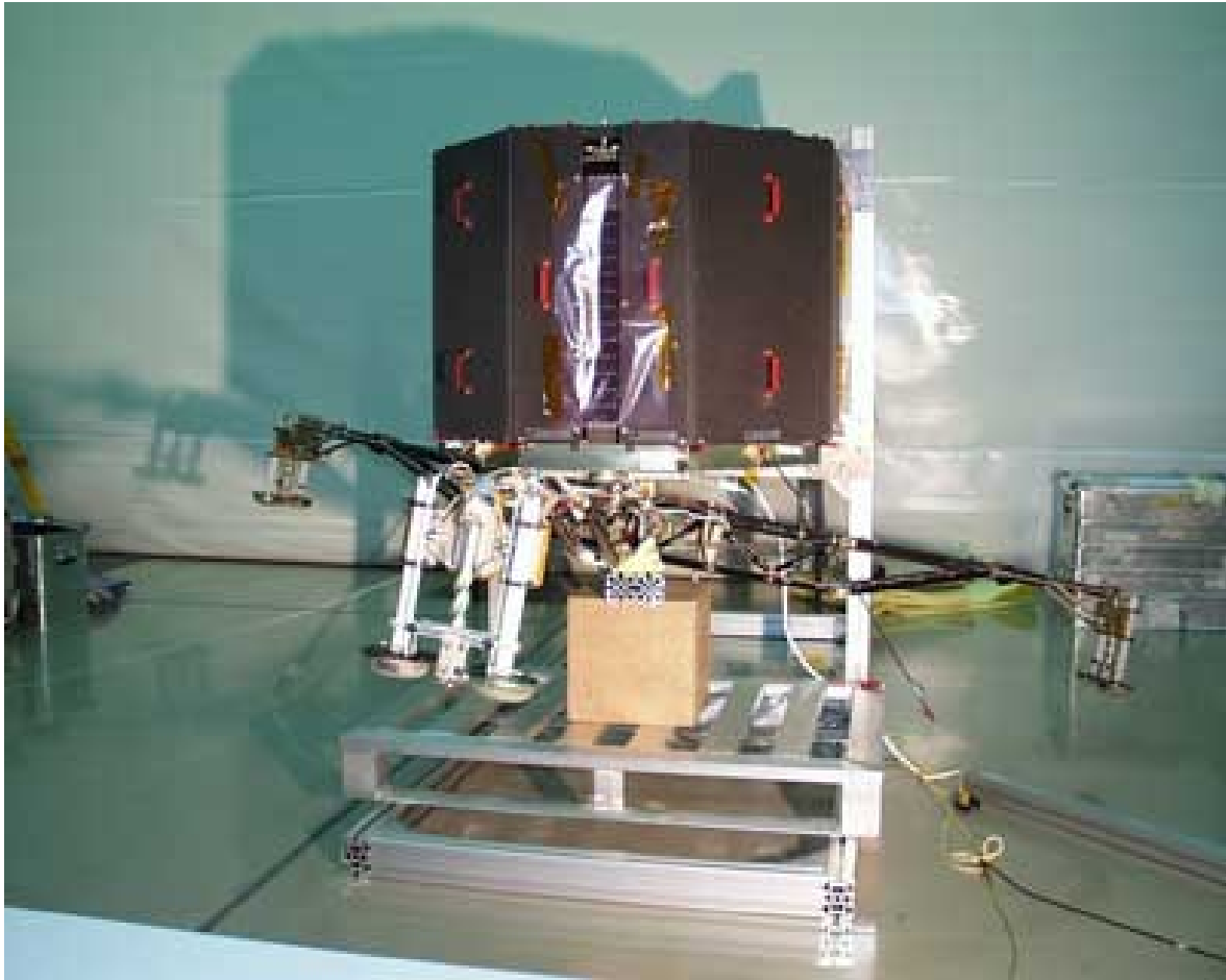
Abb. 85: Der Lander beim Zusammenbau. Die Schutzplatten (schwarz) über dem empfindlichen Solargenerator sind schon montiert. Zwei „Beine“ des Landers aus schwarzen Kohlefaserrohren werden gerade mit der Grundplatte des Landers verschraubt. Die „Füße“ und „Eisschrauben“ sind rechts im Bild zu erkennen.
