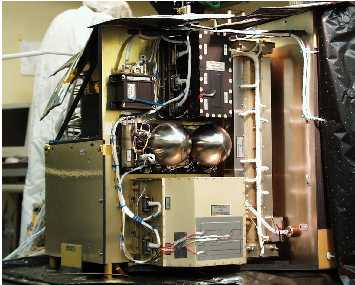
Abb. 84: Ein Blick auf das COSAC-Experiment, das bereits im Lander montiert ist. Die halbkugelförmigen Gasflaschen in der Bildmitte enthalten das für den Gaschromatographen erforderliche Helium-„Trägergas“. Der Gaschromatograph selbst ist direkt darunter montiert. Das längliche Gebilde rechts davon ist das Gehäuse des Flugzeit-Massenspektrometers. Die Elektronikplatinen befinden sich zum großen Teil in den schwarzen Gehäusen darüber.
