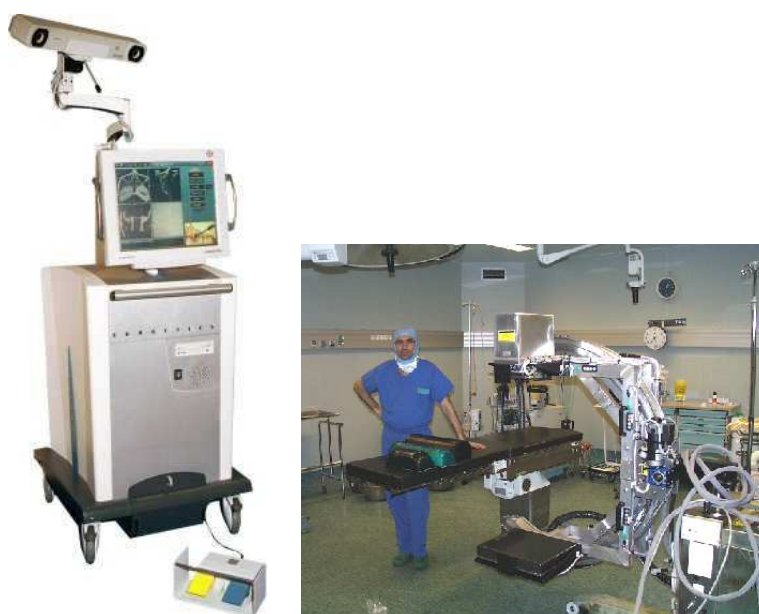
FIG. 1.14 – Le matériel autour duquel s’articule le projet MI3, contexte de ce travail de thèse : la station de navigation Surgetics de l’entreprise Praxim (à gauche), et le C-ARM interventionnel dans lequel un capteur plan dynamique de l’entreprise Trixell a été intégré.
