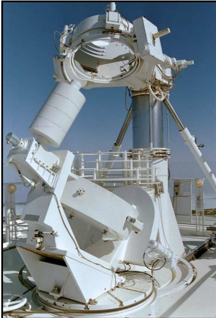
Abbildung 3.2: Coelostaten-Spiegel und Eintrittsfenster des VTT.
