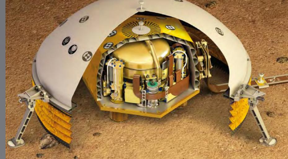
Querschnitt durch das SEIS-Instrument
