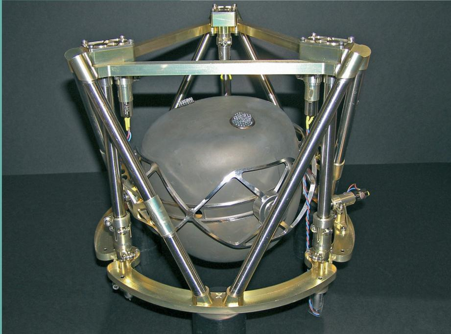
*Das Institut entwickelte eine Aufhängung und Beine mit denen das Seismometer SEIS auf Planeten und Monden exakt ausgerichtet werden kann.*
