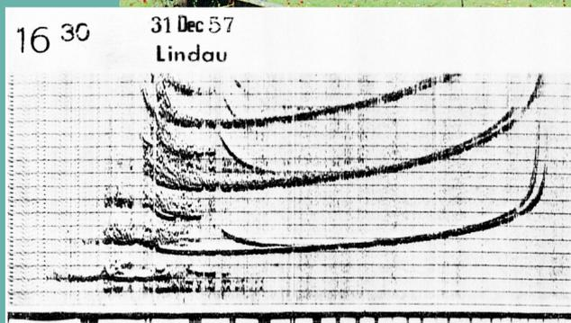
*Das Ionogramm vom 31. Dez. 1957 stellt die Reflexion von Radiosignalen aus der Ionosphäre dar.*
