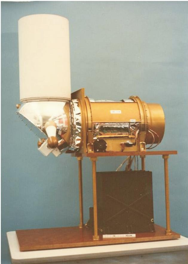
Abb. 10: Die HMC Kamera auf GIOTTO, die die ersten Bilder vom Kern eines Kometen (Halley) lieferte.
