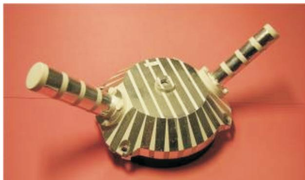
Abb. 2: Teilchenzähler auf dem ersten deutschen Forschungssatelliten AZUR. Dieses Gerät wurde am MPAE entwickelt und gebaut und begründete die lange Erfahrung auf dem Gebiet der Teilchenmessungen im Weltraum.
