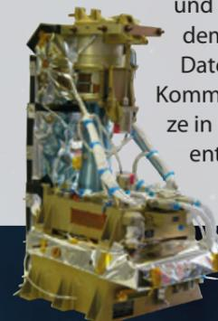
**GRaND:** Der Detektor für Gamma-Strahlung und Neutronen soll helfen, die Elemente Sauerstoff, Magnesium, Aluminium, Silizium, Calcium, Titan und Eisen sowie einige Spurenelemente aufzuspüren. Das Instrument wurde am Los Alamos National Laboratory (USA) entwickelt und wird vom Planetary Science Institute (USA) betrieben.
