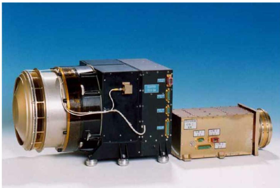
Рис. 8: Спектрометр CLUSTER Ion Spectrometer (CIS) на борту четверки аппаратов КЛАСТЕР способен измерять пространственные распределения ионов за один спин (4 секунды). CIS состоит из двух детекторов: ion Composition Distribution Function analyzer (CIS/CODIF) и Hot Ion Analyzer (CIS/HIA), а так же цифрового модуля обработки измерений Data Processing System (DPS) (Reme et al. , 1997; Rème et al. , 2001).
