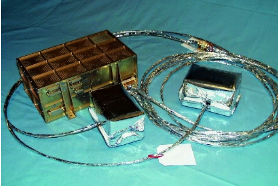
Рис. 7: Прибор Fluxgate Magnetometer (FGM) для аппаратов КЛАСТЕР, состоящий из устройства цифровой обработки (Digital Processing Unit DPU) слева и двух датчиков, соединенных с DPU кабелем (Balogh et al. , 1993, 1997, 2001).
